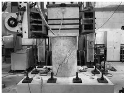
図5 No.3試験体の損傷状況 (4  $\delta_y$ 引き側)
