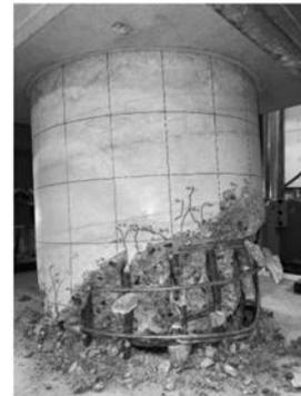
図4 No.2試験体の損傷状況 (14  $\delta_y$ 引き側)
