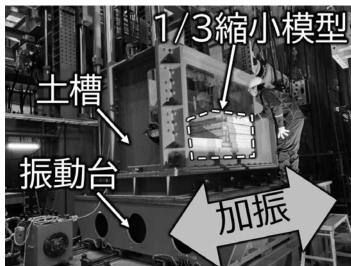
図6 水平振動台装置を用いた加振試験の概要
