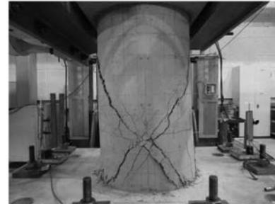
図8 No.6試験体の損傷状況 ( $6 \delta_y$ 、引き側)
