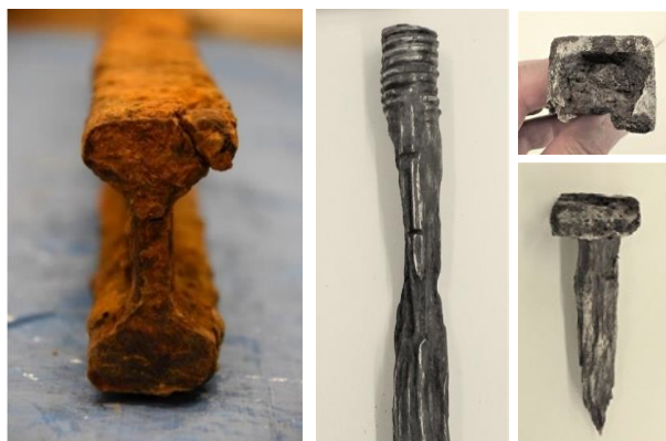
図2-5-46：双頭レール(左)とボルト状金具(右)
