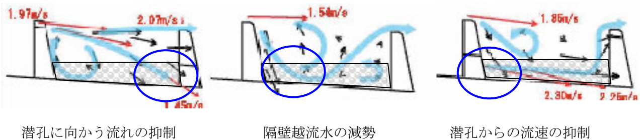
図 2-5 プール内への玉石投入の効果
