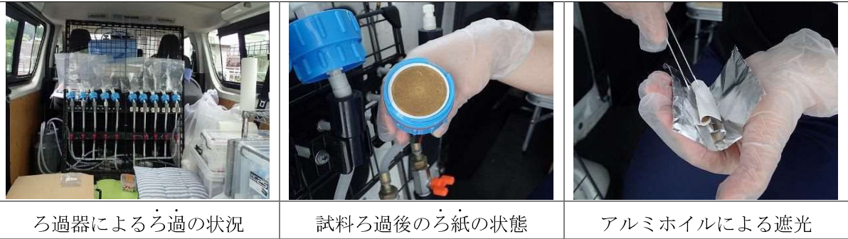
写真 3.3 現地でのろ過作業の状況
