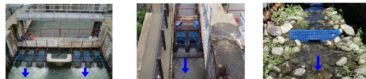
図 1.3 捕獲カゴの設置状況(左:大型魚道 中央:小型魚道 右:せせらぎ魚道)
