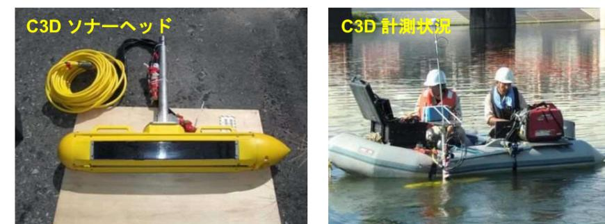
図 1.43 ソナーによる地形補足調査の機器、調査方法
