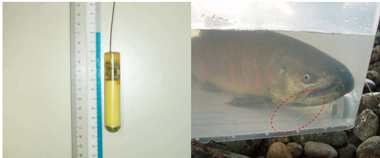
図 3.2.6 テレメトリ発信器と装着状況
