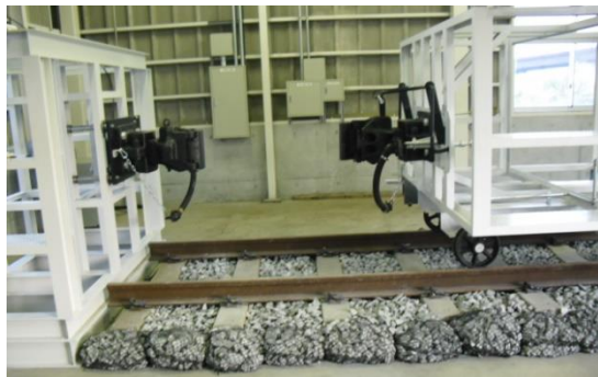
装置は車両の連結部を再現
