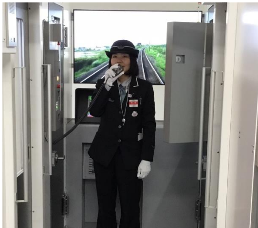
車掌用はドア開閉のスイッチや放送装置も装備
