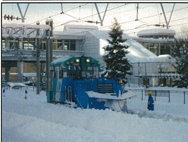
ラッセル型保守用車 線路上の雪を押しつけて走行
