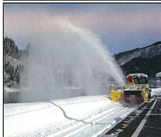
ロータリー型保守用車 線路上の雪を飛ばして走行
