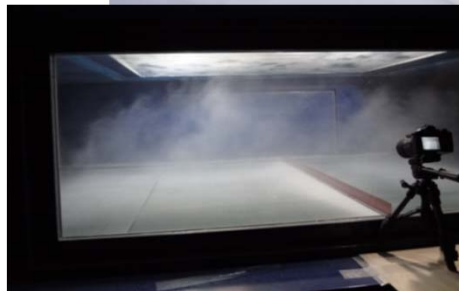
防雪柵効果確認のための降雪風洞実験
