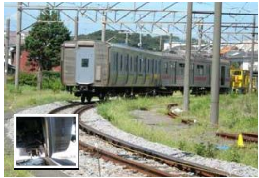
低速のり上がり脱線走行試験の状況
