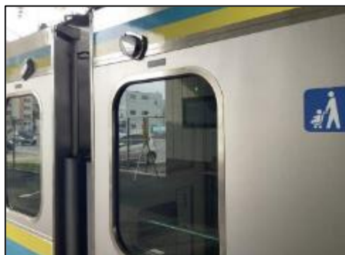
乗降確認カメラ (写真: E131系房総・鹿島エリア)
