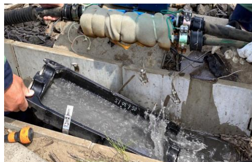
図2 浸水したクロージャ
