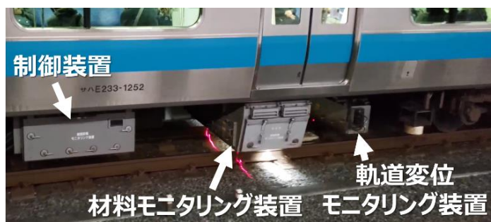
線路設備モニタリング装置
