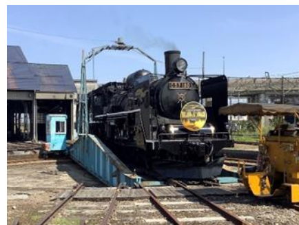
転車台での方向転換作業
