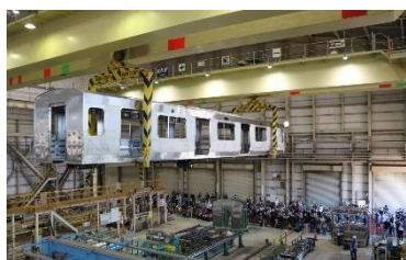
車体のクレーン移動
