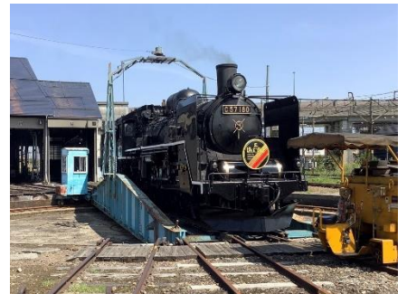
転車台での方向転換作業
