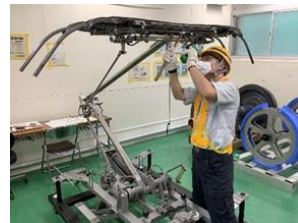
パンタグラフ点検
