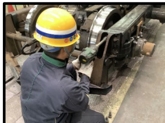
特定技能人材3名の技能実習中の様子（左から台車組立作業、台車枠排障器取付作業、輪軸測定作業）
