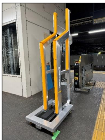
自動改札機用直立式運搬台車【Kai-Un】(試作品) (開発メーカー: 株式会社堀口工業所)
