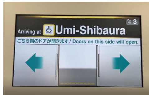
液晶カラー行先表示器設置 (写真: E131系鶴見線)
