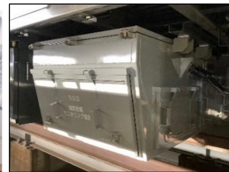
線路設備状態監視 (写真: E131系房総・鹿島エリア)
