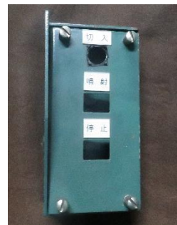
DE10 高圧洗浄機操作盤カバー
