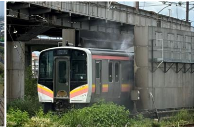
車体洗浄装置
