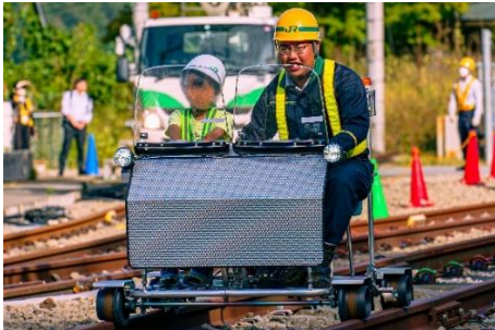
【ATカート】 線路点検に使用する車両
