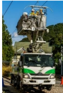
【軌陸車】 線路も走行可能な高所作業トラック
