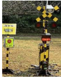
④踏切機器
