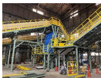
一軸破碎機 (使用済みプラスチックを細かく 破碎する機械)
