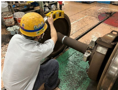
【輪軸検修作業】
