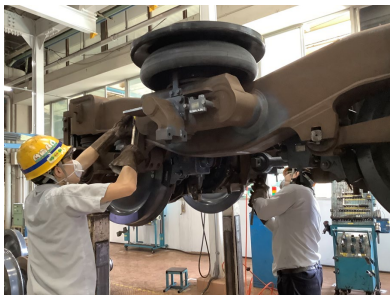
【台車検修作業】
