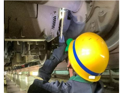
車両床下点検
