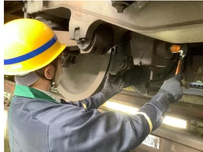
ブレーキ部品の取替作業
