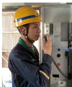
車内マイクを使用した車内放送試験
