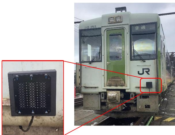
※「忌避音吹鳴装置」は、列車に取り付けたスピーカーから「忌避音」を流しながら走行することで、衝突する前に鹿が逃げよう促すことを目的としています。
