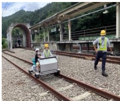
【ATカート】 線路点検に使用する車両
