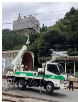
【軌陸車】 線路も走行可能な高所作業トラック
