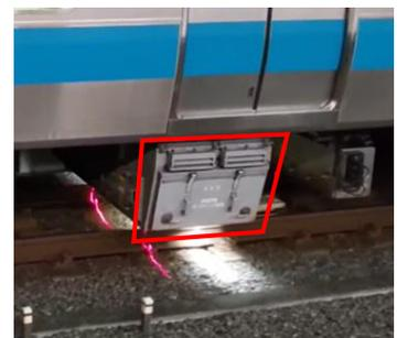
線路設備モニタリング装置
