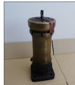
↑ ボイラー安全弁
