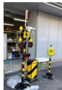
【踏切模擬装置・列車非常停止警報装置】（写真：左）
