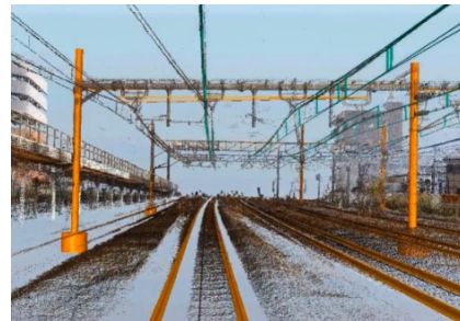
点群データから作成された3Dモデル
