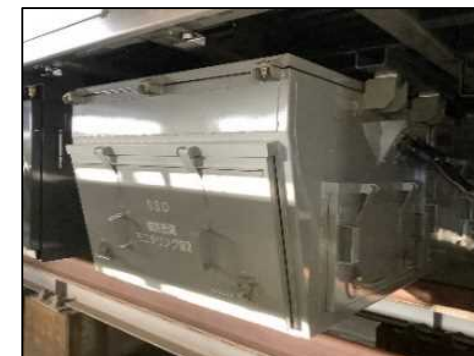
線路設備状態監視 (写真:E131系房総・鹿島)
