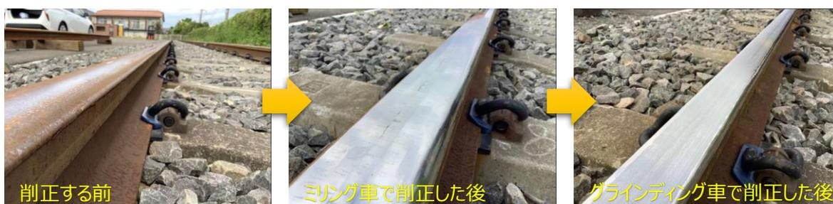
※ミリングホイールによる削正方式は当社では初めての導入、摺動式グラインディング装置の採用は日本初となります。
