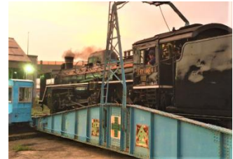
転車台を使用した方向転換作業
