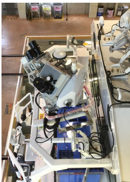
写真 4 モバイルマッピングシステム （カメラ部）
