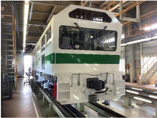
写真 1 検査駆動車の外観（背面）
