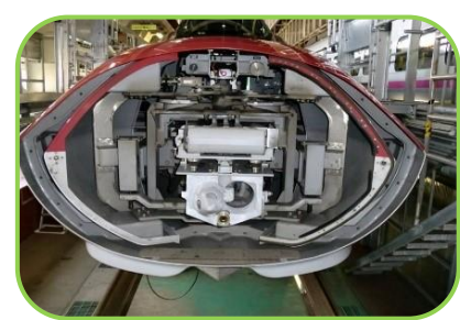
E6系併合装置カバー デモンストレーション イメージ
