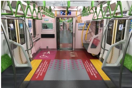
車内(フリースペース付近の床面)の案内表示
