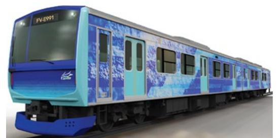
ハイブリッド車両（燃料電池）試験車両
