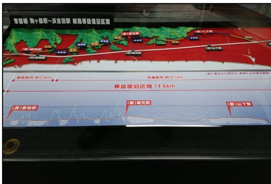
常磐線 駒ヶ嶺～浜吉田駅 被災前後の 線路移設状況
