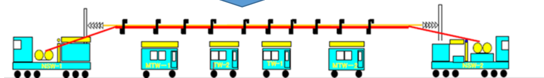
架線の接続点を撤去するため、架線張替が必要
