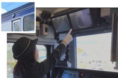
ワンマン運転設備整備
