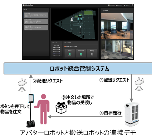
アバターロボットと搬送ロボットの連携デモ
