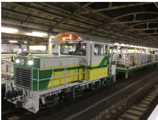
大型機械によるホームドア運搬状況
