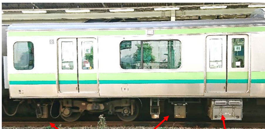
軌道変位モニタリング装置
