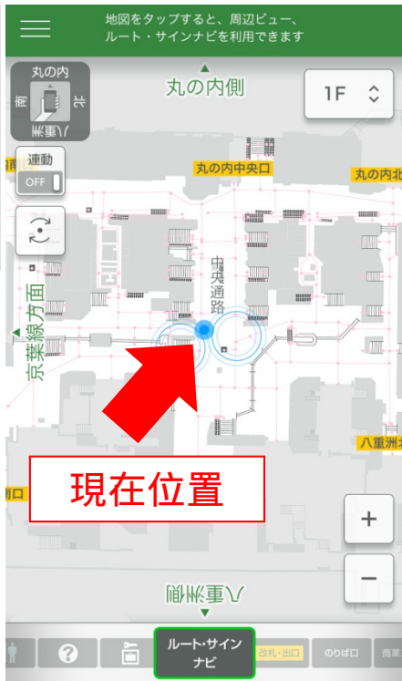
現在位置表示 無線ビーコンの電波を受信すると、地図上に現在位置を表示
