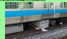
【線路設備モニタリング装置の走行試験風景】
